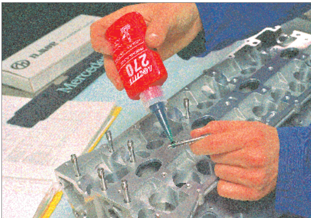
Рис. 38: 5/16" стальные шпильки с грубой резьбой закручены в алюминиевую головку блока цилиндров с использованием продукта Loctite 270. Нанесение высокопрочного фиксатора резьбы на обе поверхности - жестко закрепляет шпильки даже в случае ослабления гаек корпуса распределительного вала.
